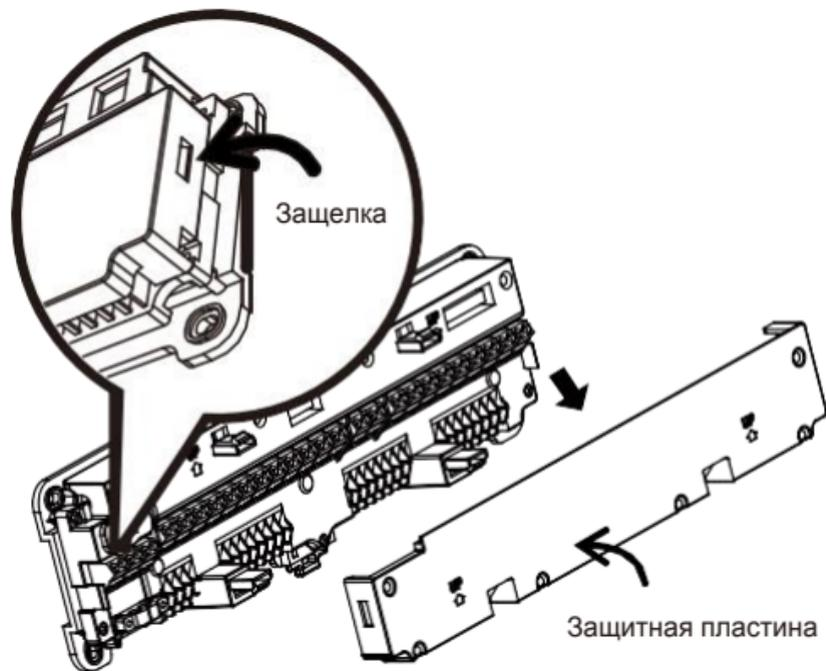
4. После подсоединения проводов закрепите заднюю панель на стене винтами (при наличии монтажного кронштейна установите панель непосредственно на кронштейн), установите защитную пластину и лицевую панель.
