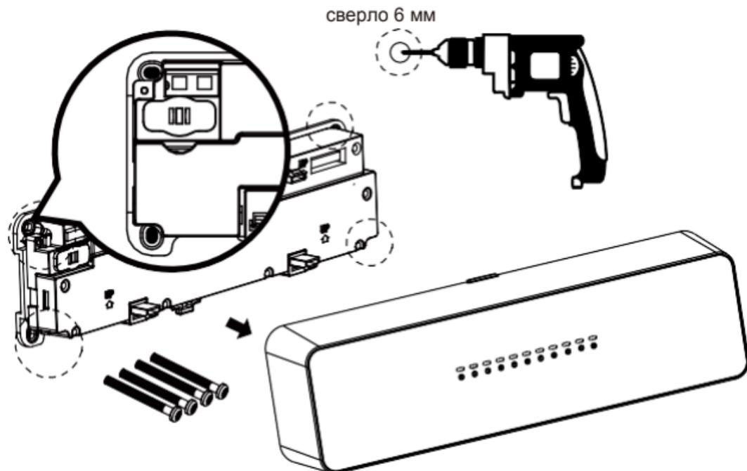
3. Нажмите на защелки и снимите защитную пластину, а затем подсоедините провода к соответствующим клеммам на задней пластине и к маркированным точкам подключения на защитной пластине.
